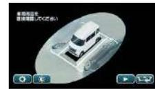
クルマの周囲360°を立体的に表示する3Dビューを採用。クルマを斜め上から見たような「室外視点」と、運転席から車体を透かして見たような「室内視点」を切り替えて表示します。
